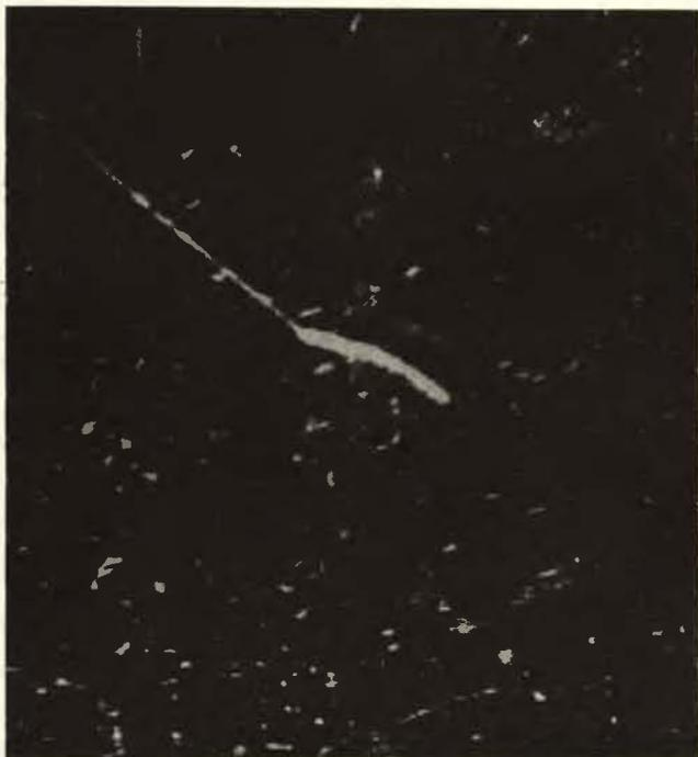
Fig. 3. — Transmutation de l'azote par un neutron de Ho + Be. La trajectoire épaisse et courte et celle de  $B_{11}$  et la trajectoire fine est celle d'une particule  $\alpha$ .
