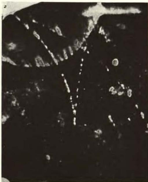
Fig. 8. — Paire d'électrons positif et négatif créés dans le gaz par un photon de  $\text{ThC}''$ .
