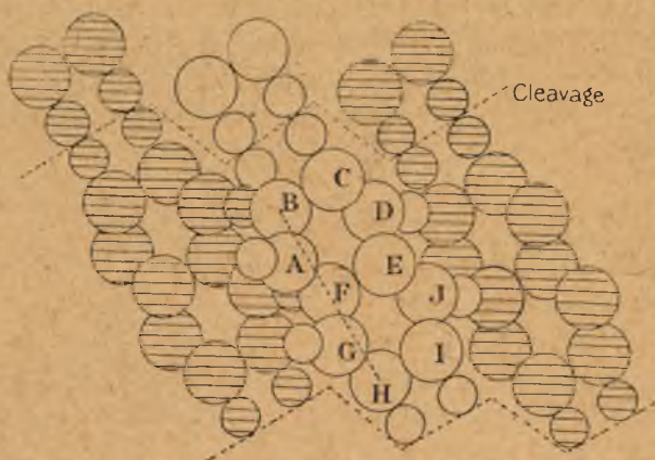
Fig. 14. — Relations de trois molécules de naphthaline et de portions d'autres molécules.
