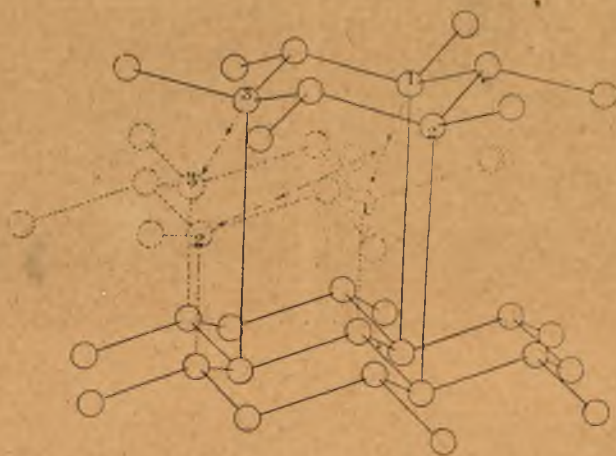
Fig. 9. — Les lignes pleines montrent la structure du graphite. En amenant la couche supérieure sur les lignes pointillées, on obtient la structure du diamant.
